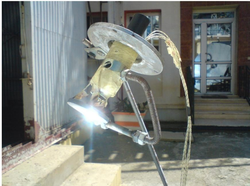
Figure 5.9 : détermination de la distribution de la température sur la plaque cylindrique Le 24/06/2010.
