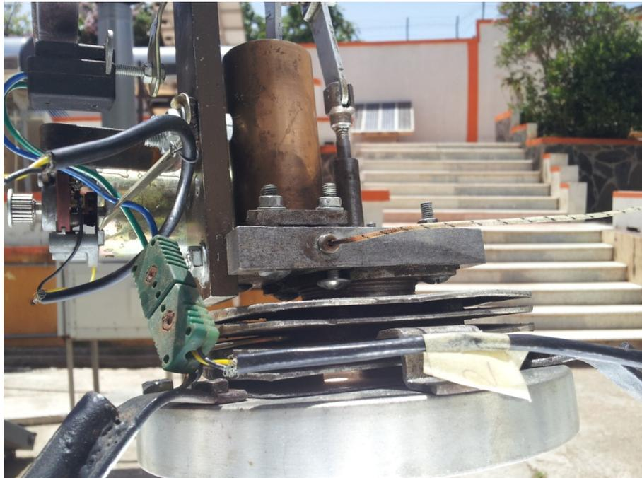
Figure 5.4 : Installation du thermocouple.
