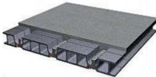
Figure I.2: Plancher à corps creux
