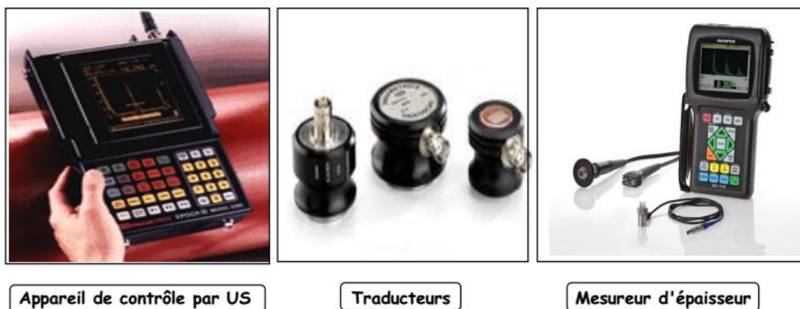
Figure 2-10: appareil de contrôle, traducteurs et mesureur d'épaisseur.
