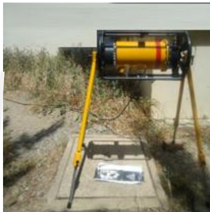
Figure5-20: Contrôle radiographique des pièces de bloc de frein
