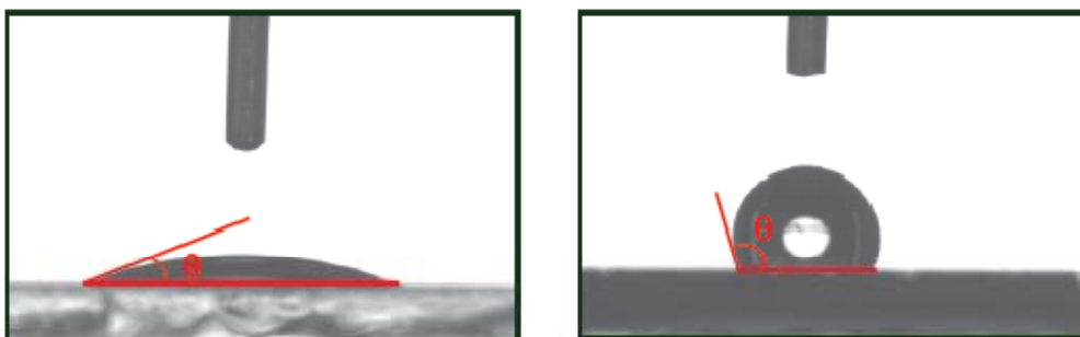
Figure.6: Goutte d'eau sur une surface hydrophile \theta = 5^\circ (gauche) et sur surface hydrophobe (droit)
