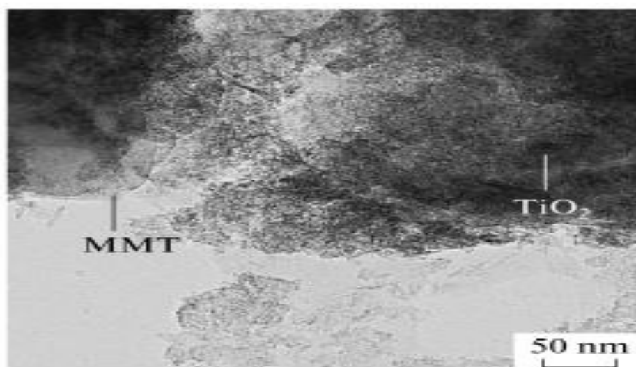
Figure 4.14: Microscopie électronique à transmission (MET) de \text{TiO}_2 -Mt [114].
