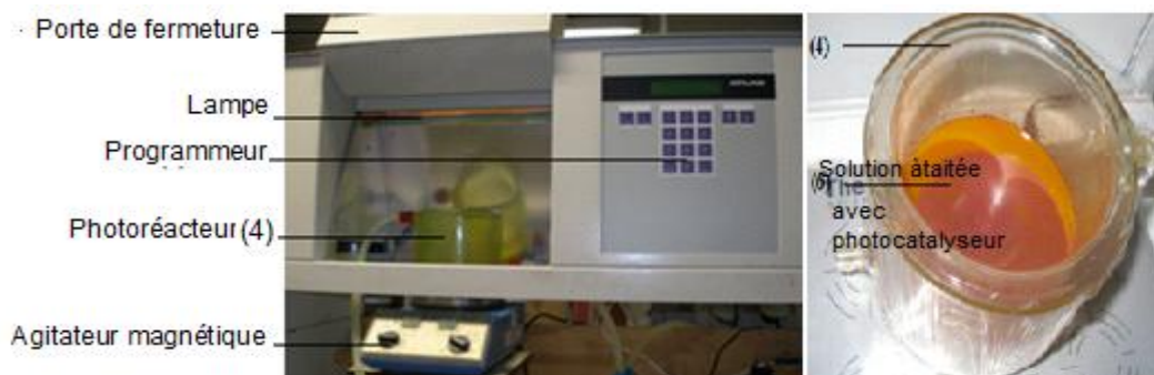
Figure 3.3 : Photographie du photoréacteur Sun-test CPS+
