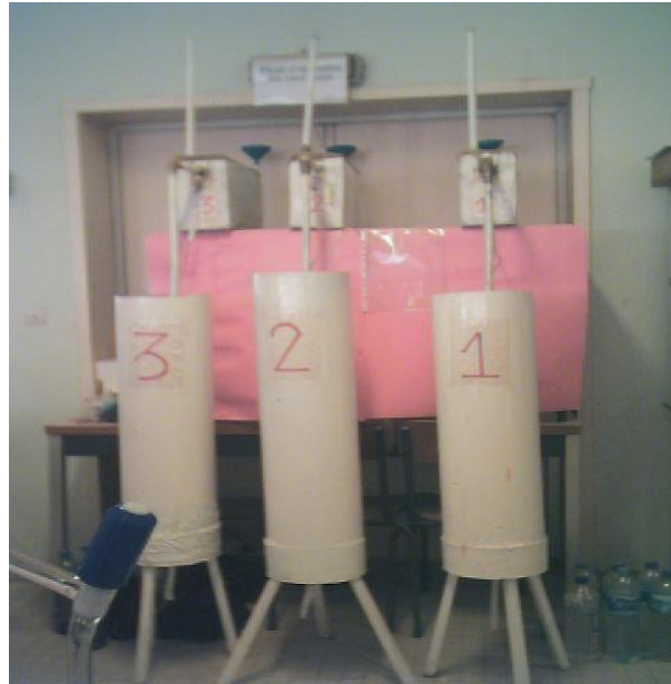
Photo 1 : les trois pilotes d'épuration des eaux usées
