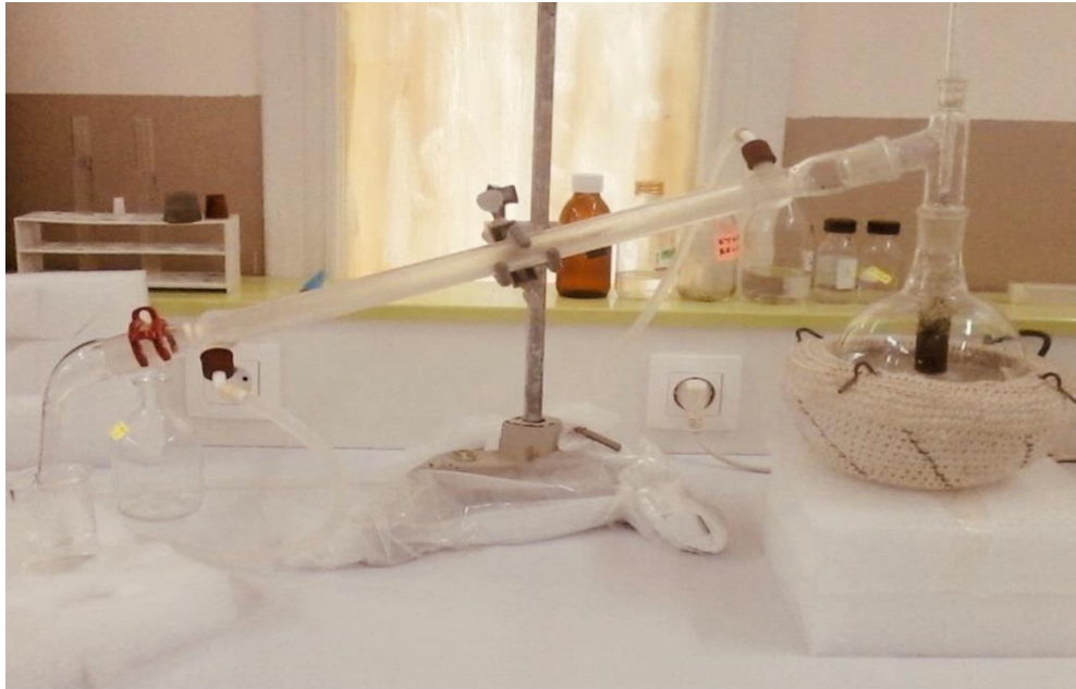
Figure 2.3 : Préparation de la fraction volatile à l'aide du montage Dean-Starck modifié
