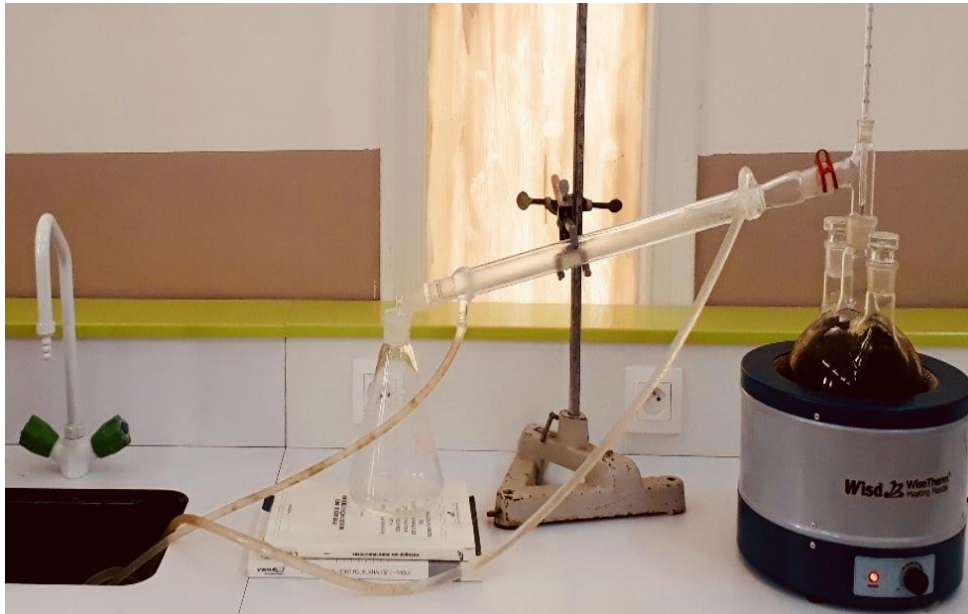
Figure 2.2: Montage d'extraction de l'huile essentielle par Hydrodistillation
