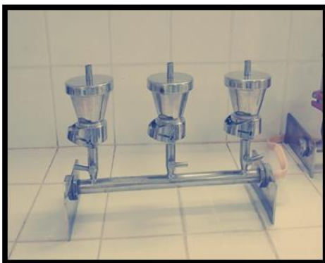
Figure 45 : Rampe de filtration
