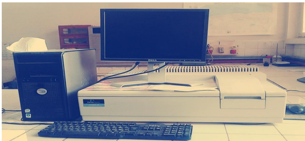
Figure 35 : Spectromètre (UV/VIS) pour le dosage des nitrates et nitrites
