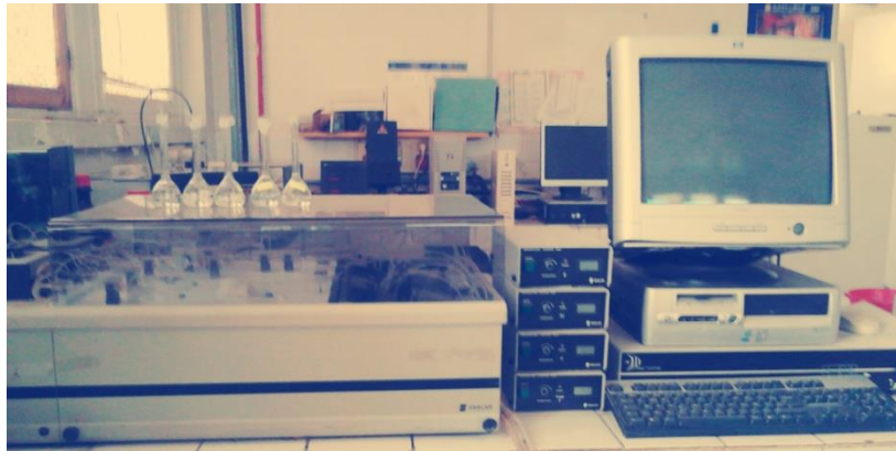
Figure 36 : Auto Analyseur pour le dosage de phosphate
