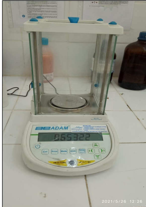
Figure : Balance de précision de 10^{-4} g.
