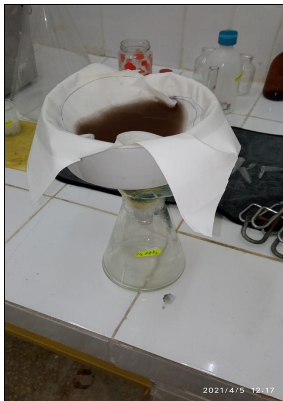
Figure : filtration de la poudre de Phase MAB
