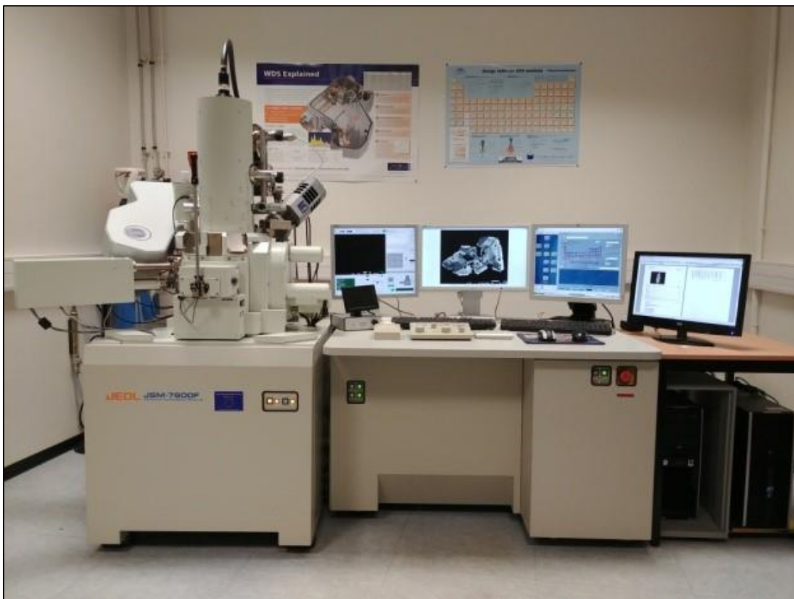
Figure : Microscope électronique à balayage (MEB)
