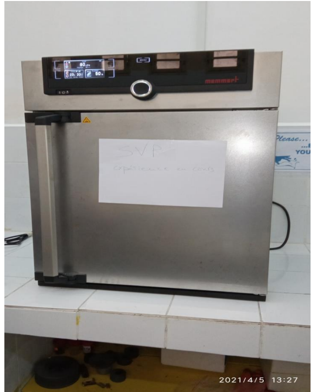
Figure : Etuve de Marque 'Memmart' qui contient la poudre de Phase MAB
