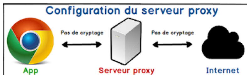
Figure I.10 — Configuration du serveur proxy
