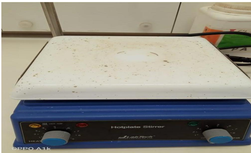
Figure II. 3: Agitateur magnétique de type Labtch.
