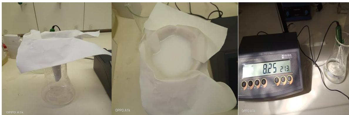
Figure II. 17: Les étapes de filtration, lavage et mesure de pH.
