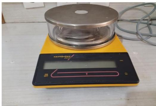
Figure II. 1: Balance électronique de type Sartorius Basic.
