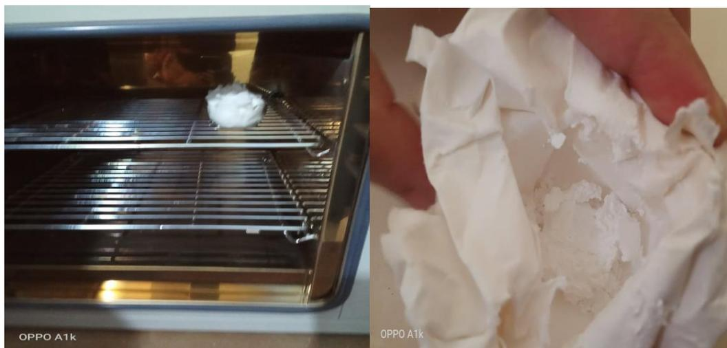
Figure II. 18: La poudre obtenue après 24H de séchage.
