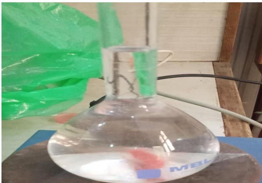
Figure II. 15: Solution d'agent précipitant sous l'agitation.
