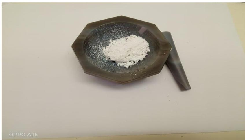
Figure II. 2: Mortier et pilon en agate.
