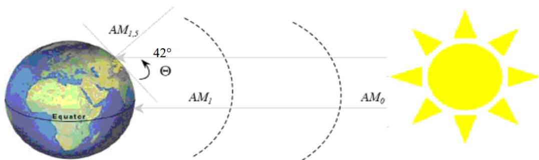
Figure 1.1 : Description de nombre d'air –masse ; AM0 (spectre solaire en dehors de l'atmosphère), AM1 (spectre solaire au sol lorsque le soleil est situé au zénith) et AM1.5 (spectre solaire au sol pour un rayonnement solaire ayant un angle d'incidence de 48,2°).
