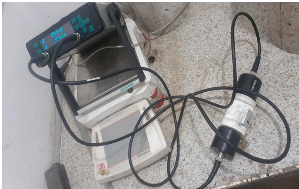
Figure 2. 26: Etalonnage de l'ultrason à l'aide du barreau de calibrage.
