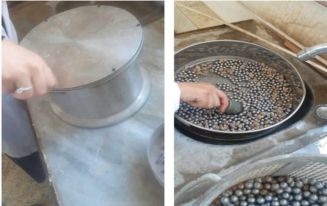
Figure 2. 20: Récupération et séparation du matériau.
