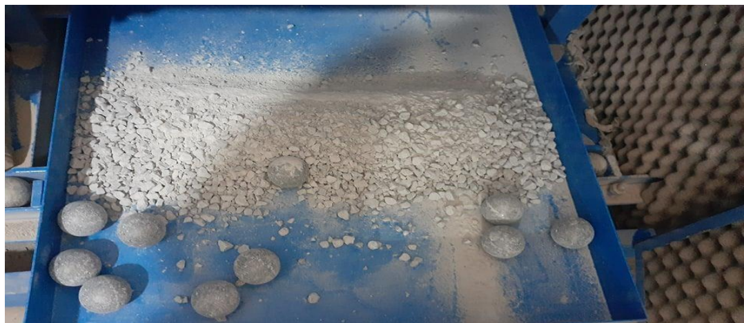
Figure 2. 16: Etat du granulat en fin d’essai (500 tours).
