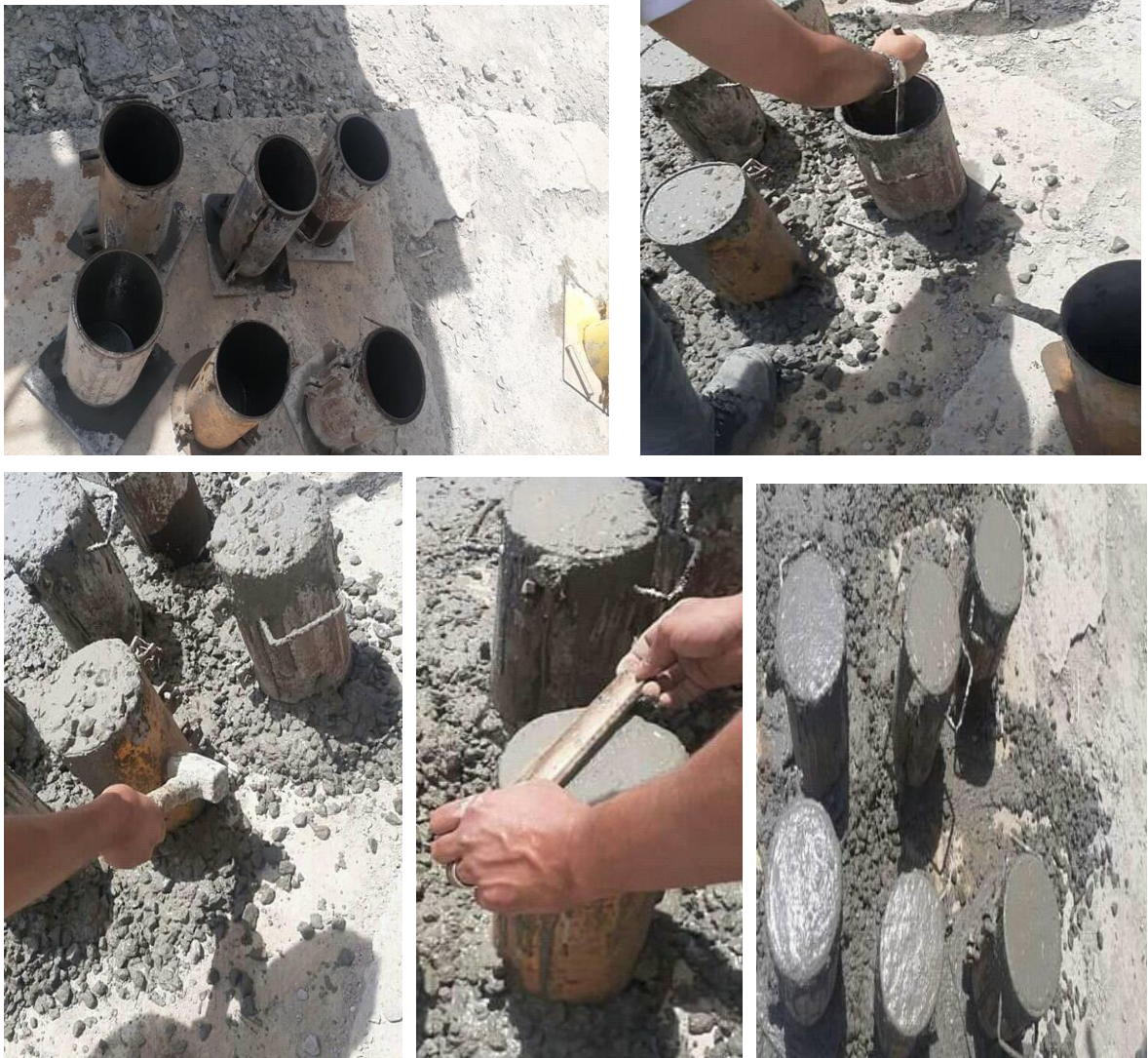
Figure 2. 23: Les étapes des prélèvements de béton.
