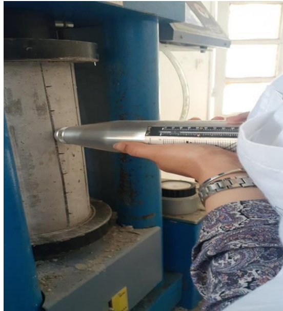
Figure 2. 29: Mesure de l'indice de rebondissement par le scléromètre.
