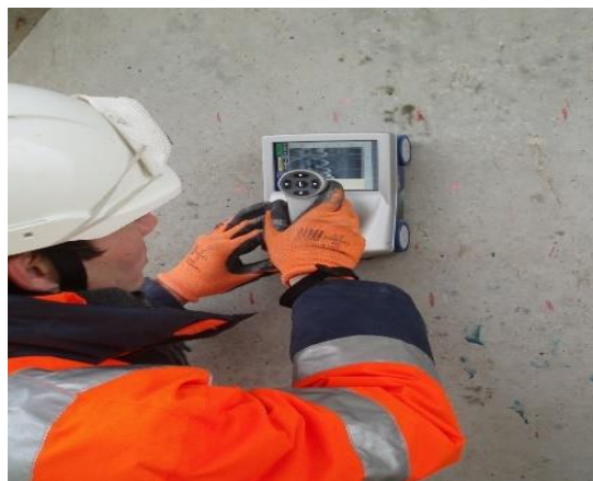
Fig. 2.25 : Méthode du radar
