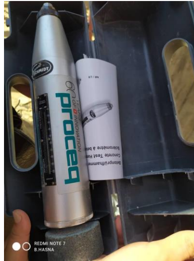
Fig. 2.6 : Appareil de scléromètre (marteau de rebondissement de Schmidt type N).
