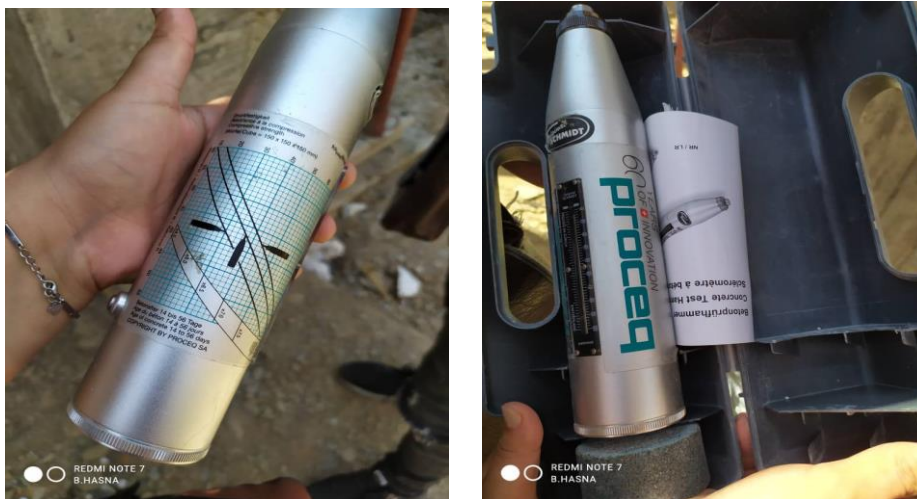
Fig 3.9: Appareil du scléromètre utilisé.
