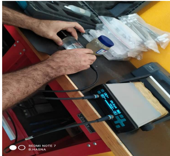
Fig 3.14 : Etalonnage de l'ultrason à l'aide du barreau de calibrage.
