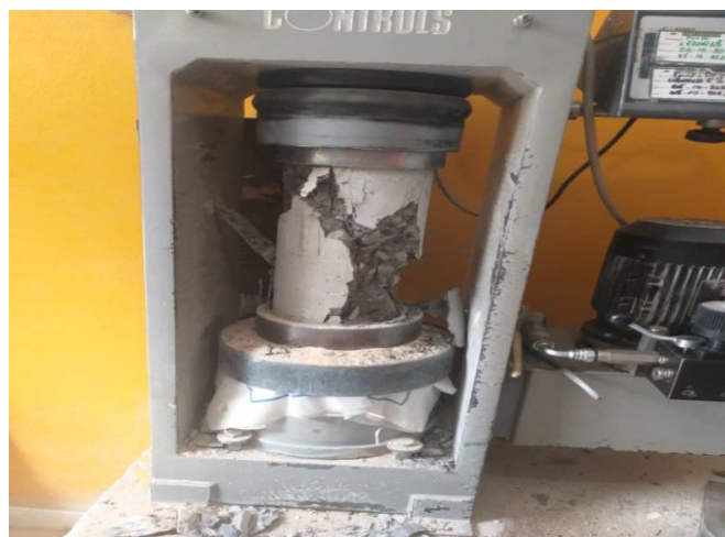
Fig. 2.1 : Eprouvette cylindrique pour essai de compression
