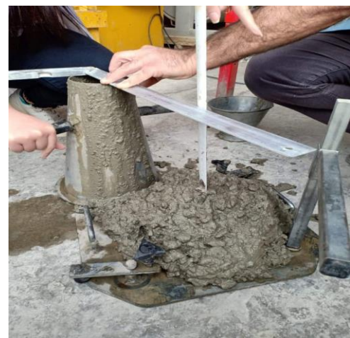
Fig 3.6: Essai d’affaissement au cône d’Abrams.
