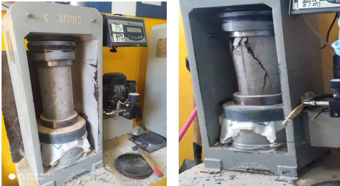
Fig 3.18: Essais d'écrasement des éprouvettes.
