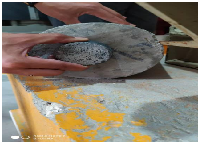
Fig 3.13 : Ponçage des éprouvettes à l'aide de la pierre abrasive.
