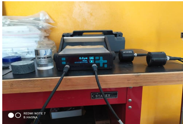
Fig. 2.16 : Appareil d'auscultation sonore avec oscilloscope.
