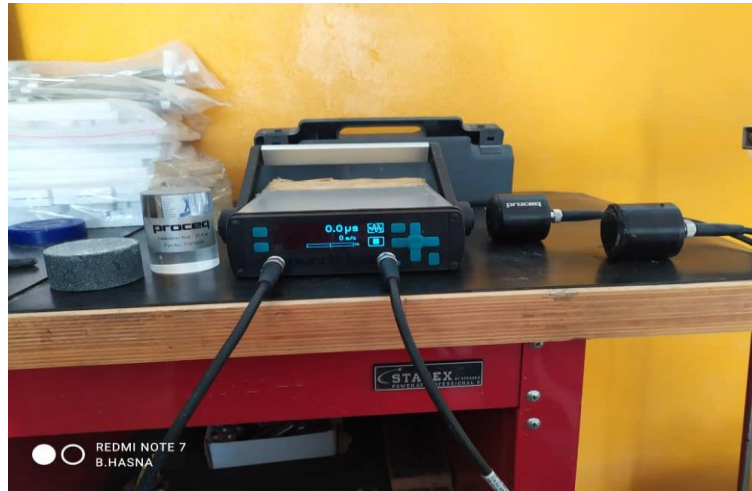
Fig. 3.10 : Appareil de l'ultrason utilisé.
