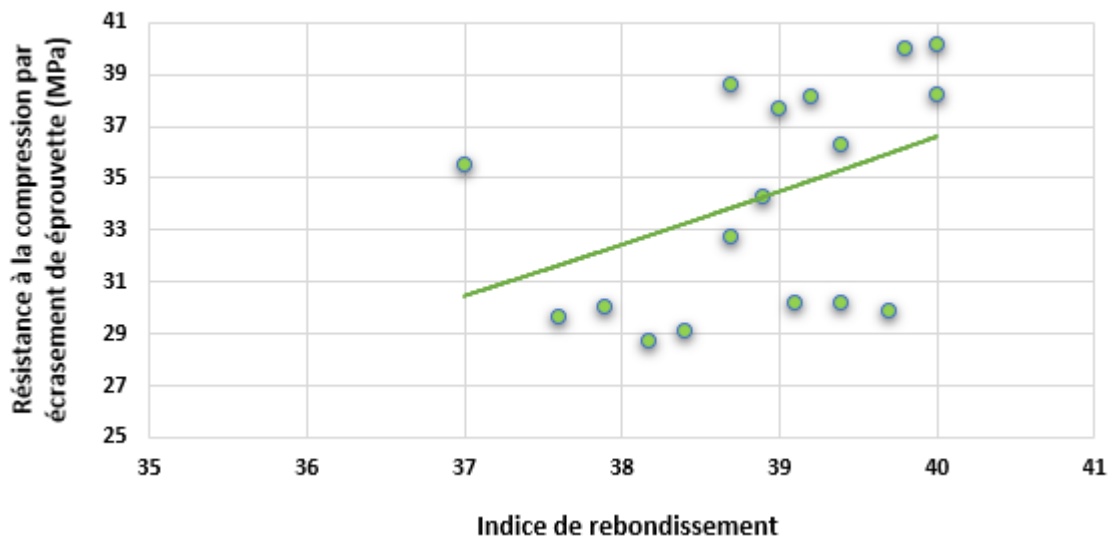
Fig. 4.3 : Corrélation Résistance-Indice de rebondissement proposé pour l'ensemble de résultats de B2.
