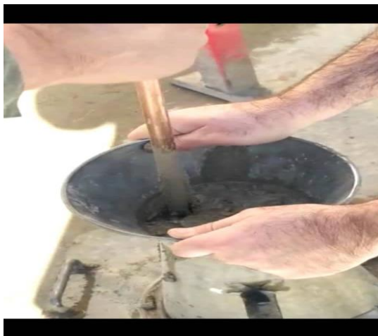
Fig 3.6: Essai d’affaissement au cône d’Abrams.
