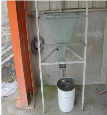
Fig.1.3 : Consistomètre de v-funnel.
