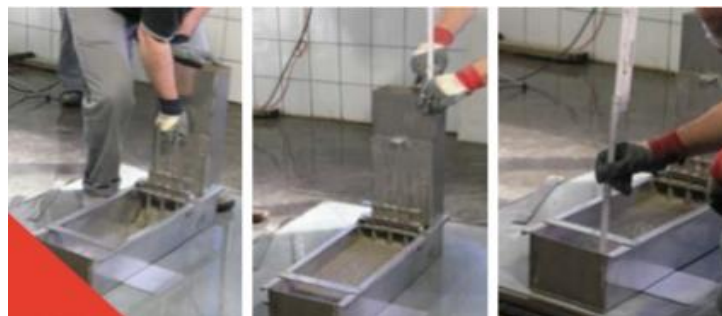
Fig. 1.4 : Consistomètre de Boite en L.
