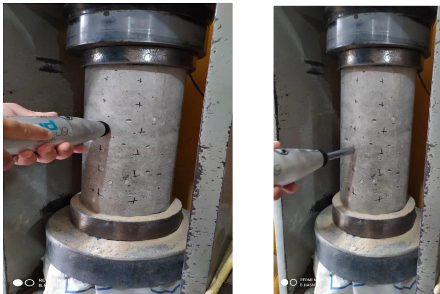
Fig 3.17 : Essai de scléromètre (mesure l'indice de rebondissement).
