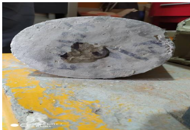
Fig 3.15: Le graissage des faces d'éprouvette avec la vaseline.
