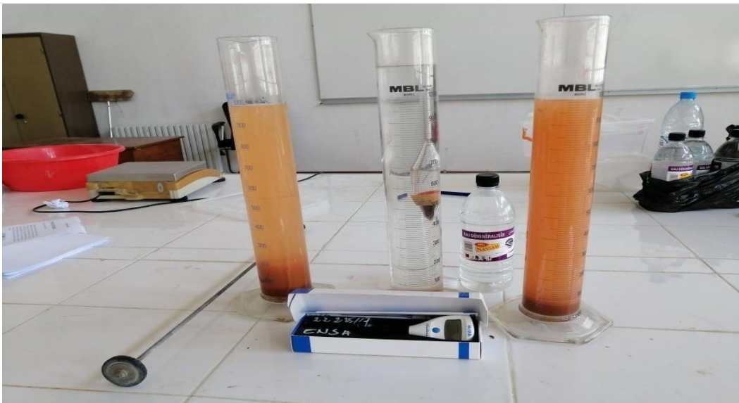
Figure III. 12: Analyse granulométrique par sédimentation de la brique.
