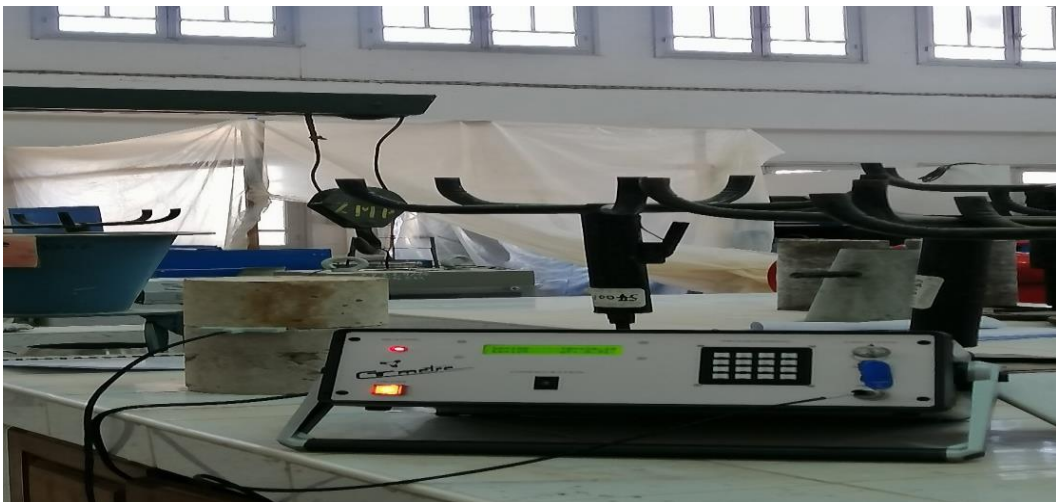
Figure III. 28: Appareils CT-mètre utilisé.
