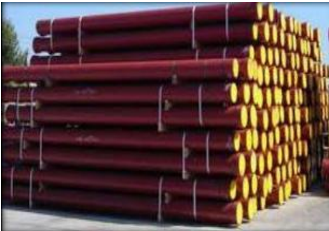
Figure 12: Canalisations en Ductile
