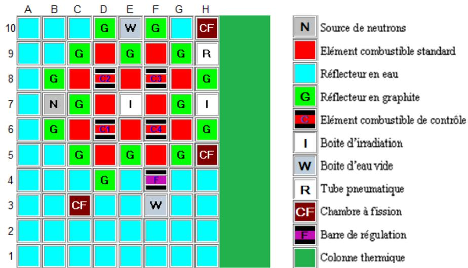
**Fig.2.2 :** Configuration de démarrage (IV-N) et actuelle (X-1) du réacteur NUR.
