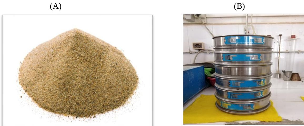
**Figure II.2 :** photographies numérique montrant : (A) sable d'Oued Souf (B) la série des tamis.
