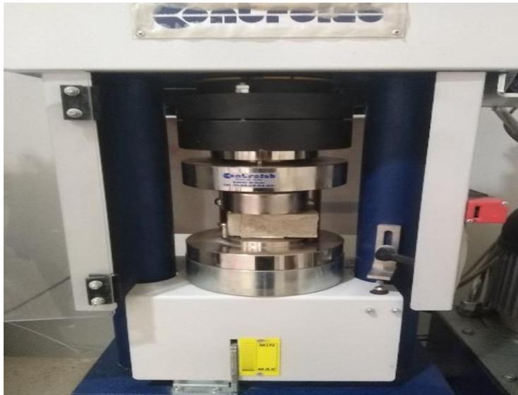
**FigureII.7** : Photographie numérique montrant la presse hydraulique utilisée dans les essais mécaniques (Flexion 3 points).
