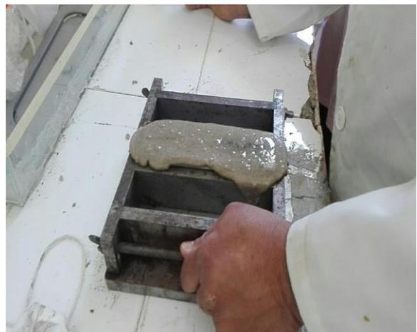
Figure II.5 : Photographies numériques montrant (A) : Etape de malaxage (B): Moulage de mélange dans le moule.
