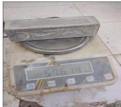
**Figure II.8** : Photographies numériques montrant les appareils utilisés dans les test d'absorption d'eau. (A) : bassin d'eau (B) : balance
