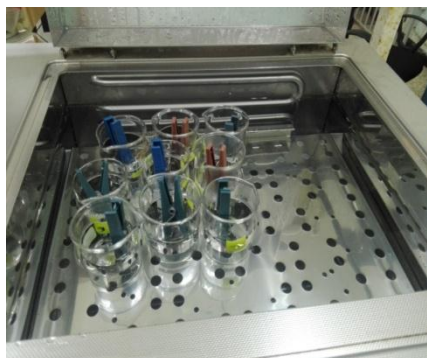
Figure 3. 5. Photos représente les dispositifs Expérimental de la technique de masse perdue
