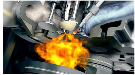
Figure 1- 5 : Moteur Diesel et l'injection de carburant dans la chambre de combustion
