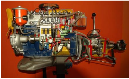
Figure 1- 5 : Moteur Diesel et l'injection de carburant dans la chambre de combustion
