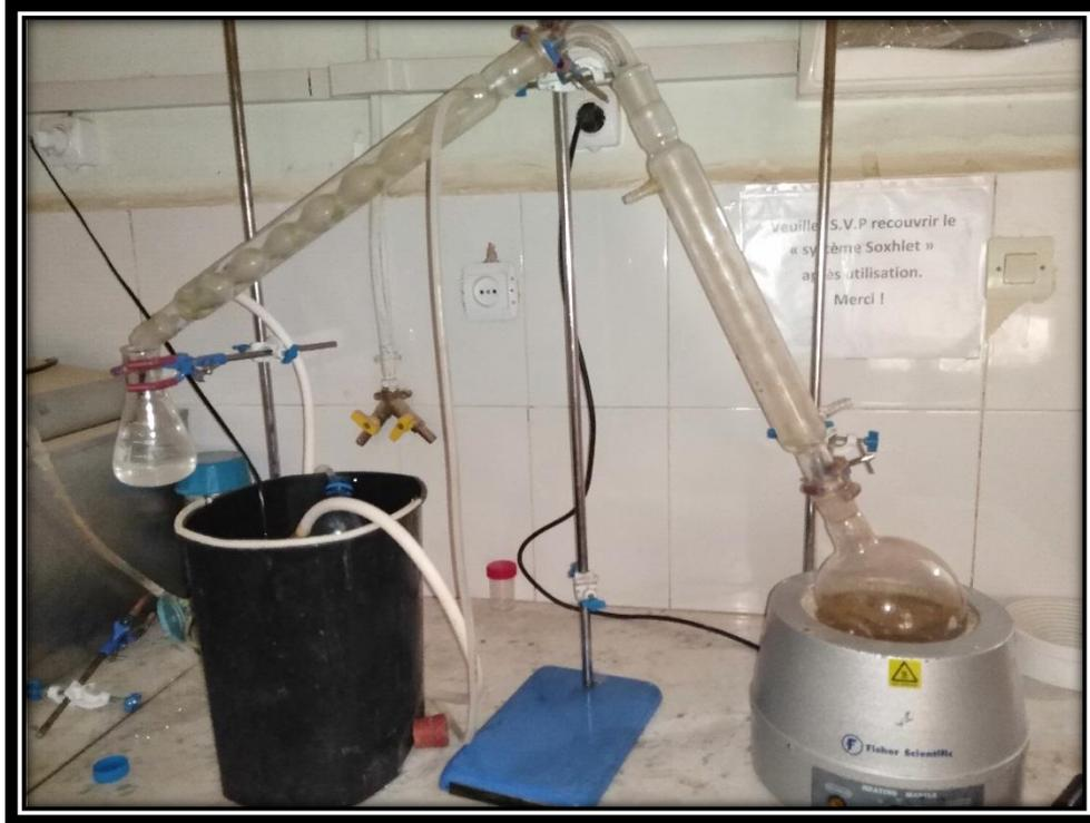
**Figure 3.11:**Montage de la distillation alcoolique.
