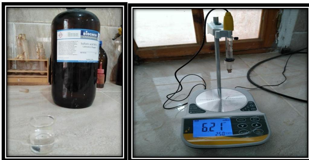
**Figure 3.7.** Ajustement pH du moût.
