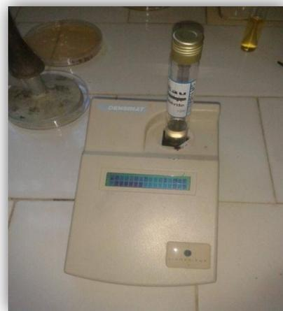
**Figure 6:** Densitomètre
