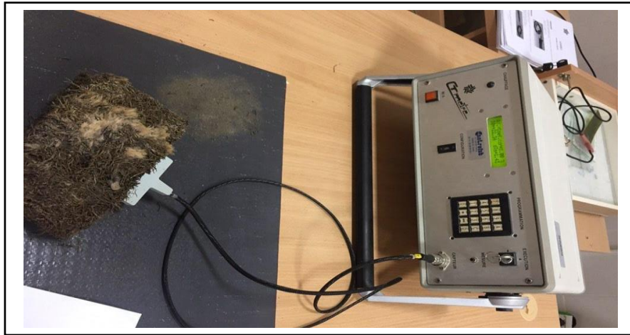
Figure 2.5 : Montage du CT Mètre et l'échantillon.
