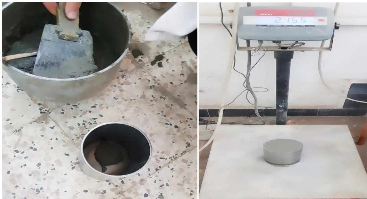
Figure 3-28: mesure des masses volumiques apparentes des mortiers.
