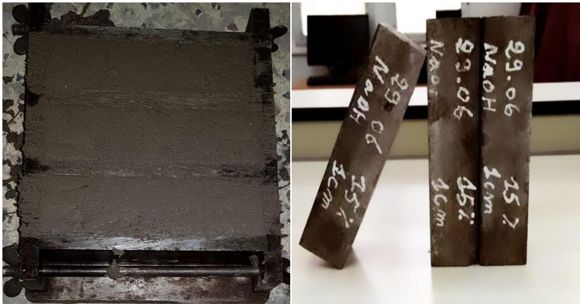
Figure 3-23: Application du mortier de réparation dans les moule 40 \times 40 \times 160 \text{ mm} .
