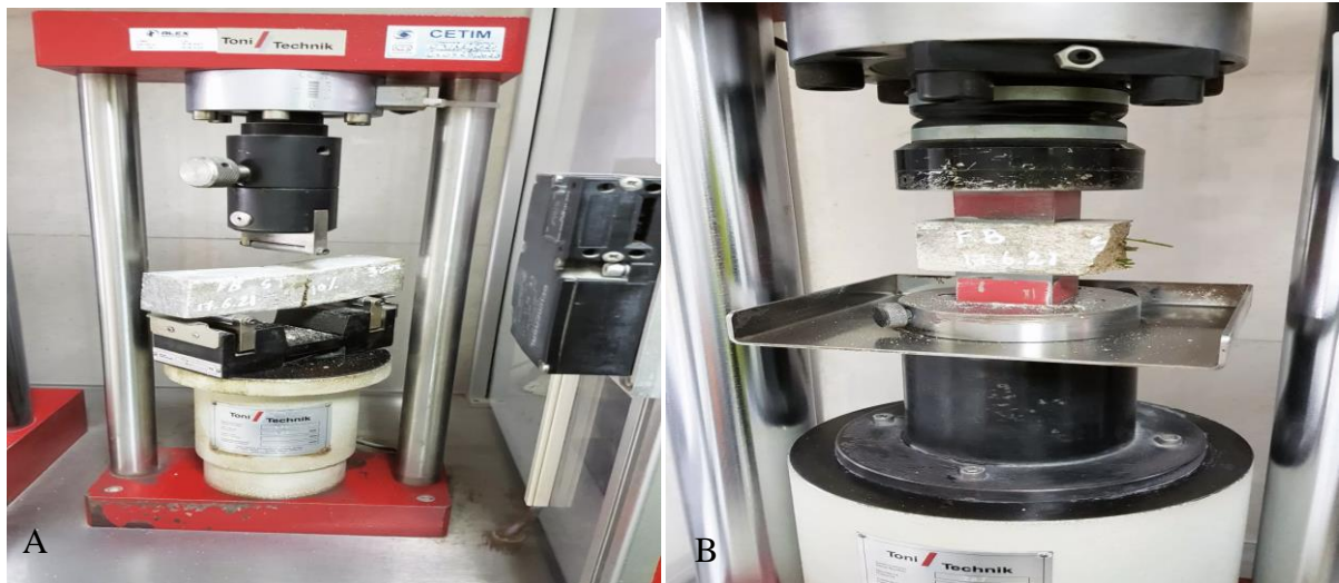
Figure 3-30: A) Essai de résistance à la flexion ; B) Essai de résistance à la compression.
