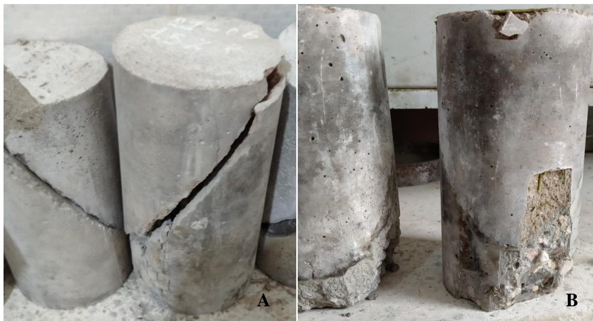
Figure 4-13: spécimens cylindrique après l'essai d'adhérence par cisaillement oblique; A)- spécimens de réparation en mortier sans fibres; B)- les spécimens de réparation en mortier renforcé par des fibres d'alfa.
