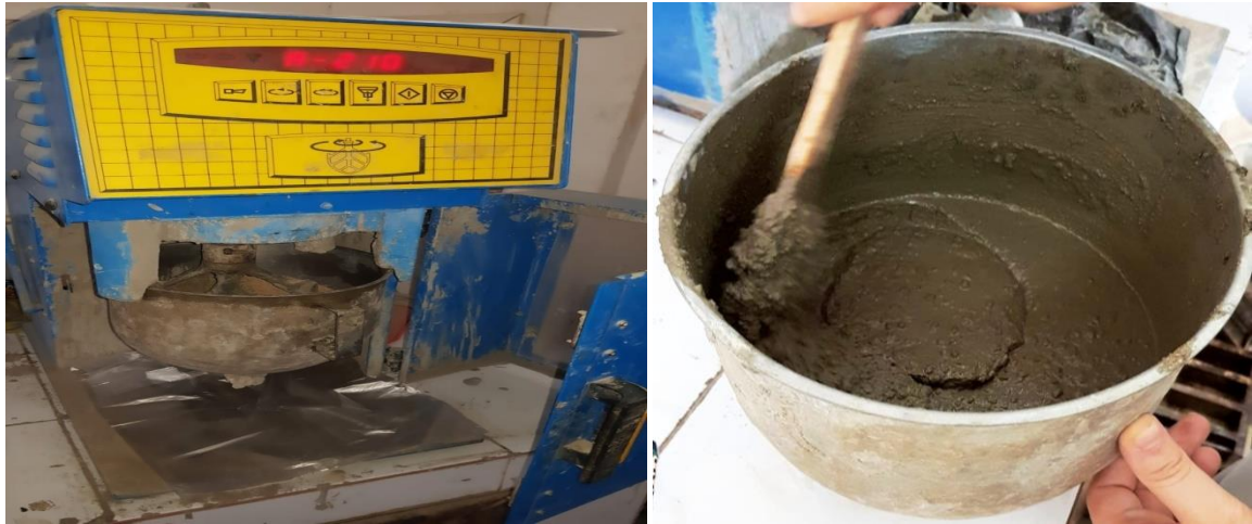
Figure 3-20: Formulation du mortier de réparation.
