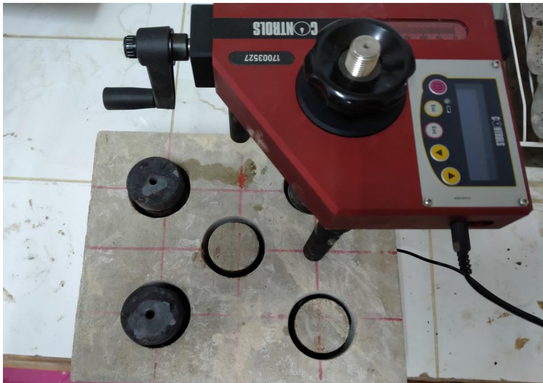
Figure 3-34: Essai d'adhérence par arrachement.
