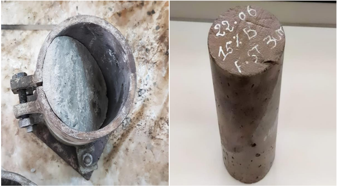
Figure 3-22: Application du mortier de réparation sur les éprouvettes cylindrique.
