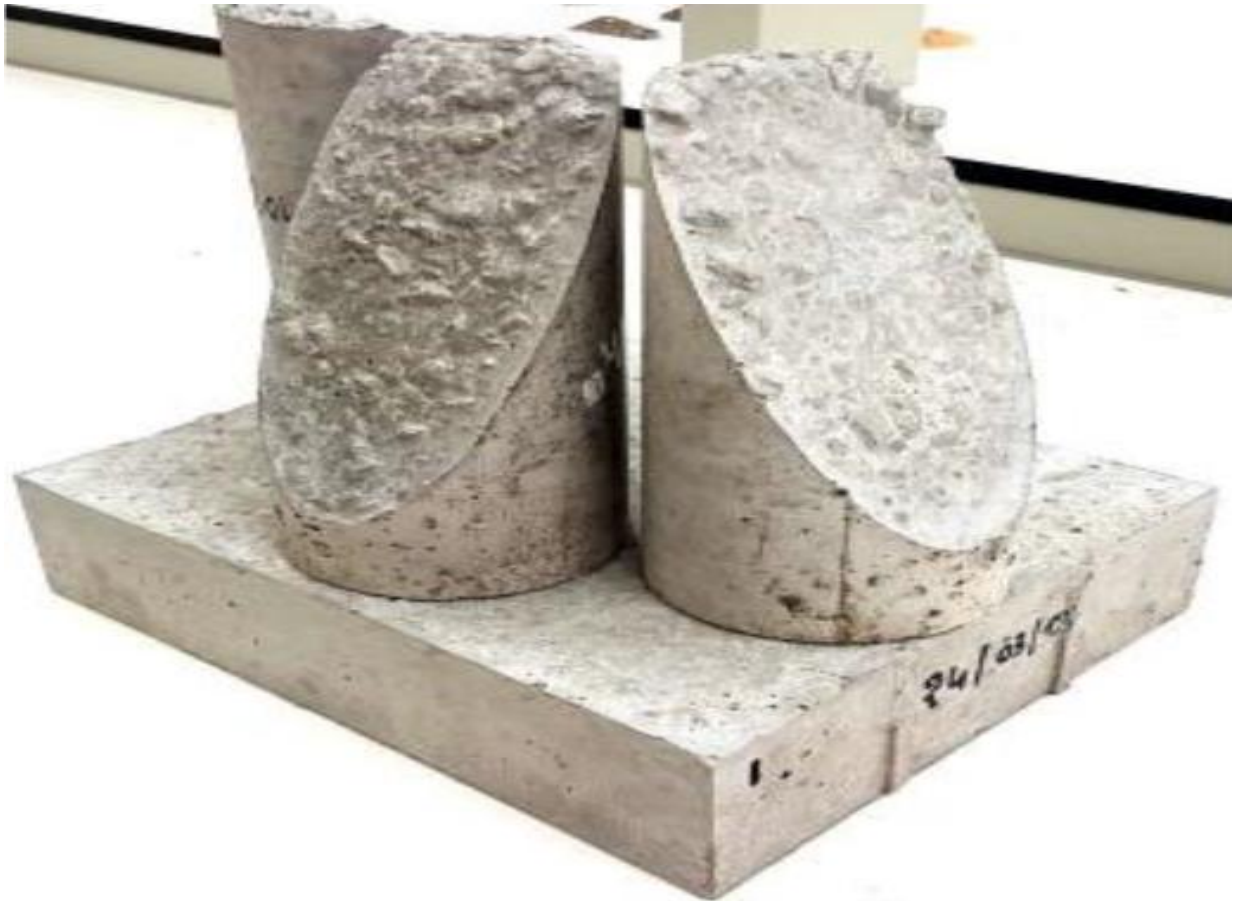
Figure 3-18: Demi-cylindre et dalle en béton.
