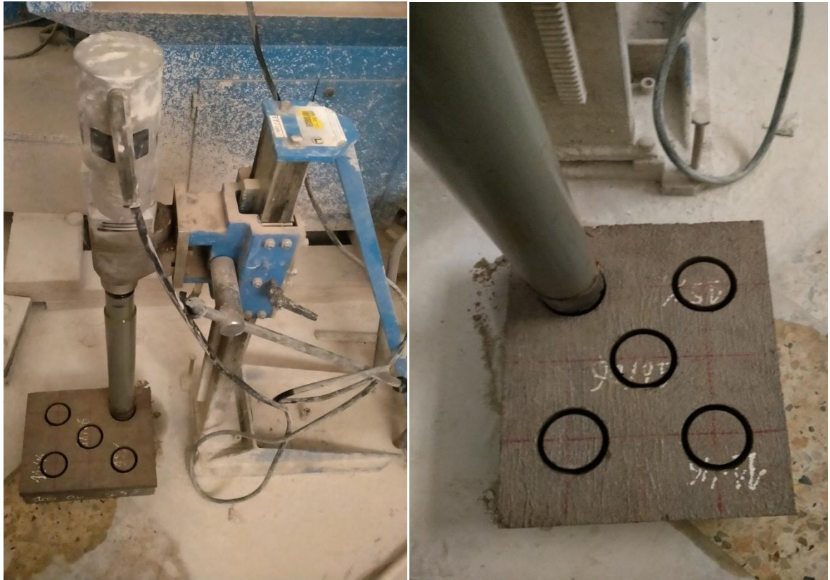
Figure 3-33: Carottage des dallâtes.
