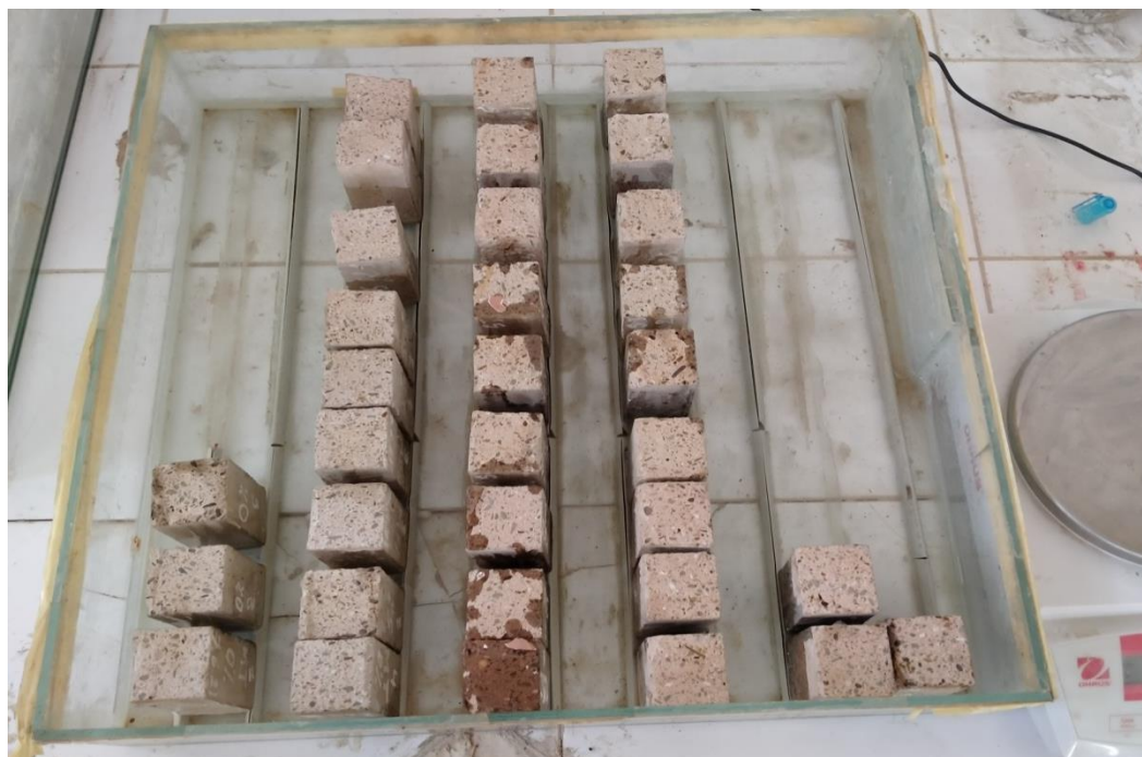
Figure 3-37: Essai d'absorption capillaire.
