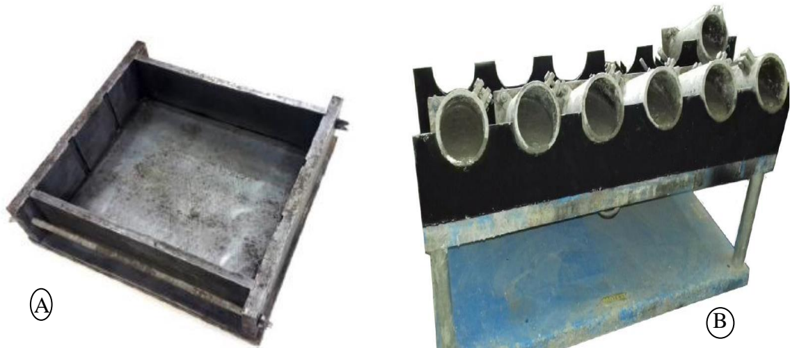
Figure 3-17: A) Moule pour les dalles en béton 70×230×280. B) Dispositif d'inclinaison 30° pour les moules cylindriques.
