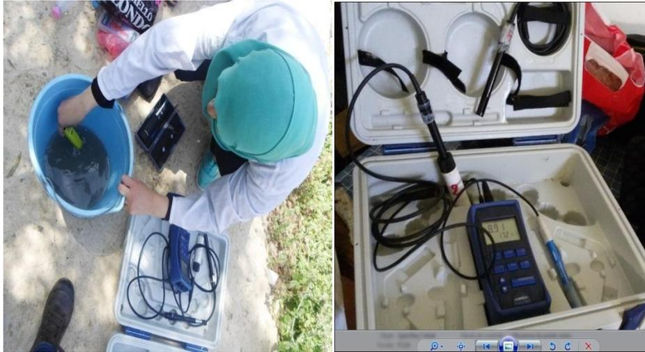
Figure 16. Multi-paramètre (photo originale).
