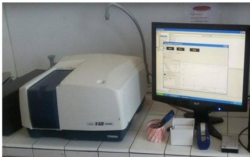
Figure17. Un spectrophotomètre utilisé pour l'analyse chimique
