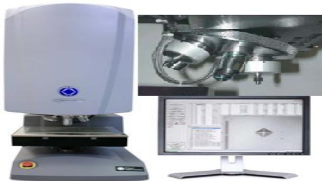
Figure II.10. Machine d'essais Micro Dureté. [Disponible au niveau de l'université Ferhat Abbas (Sétif) dans laboratoire de matériaux non métallique]
