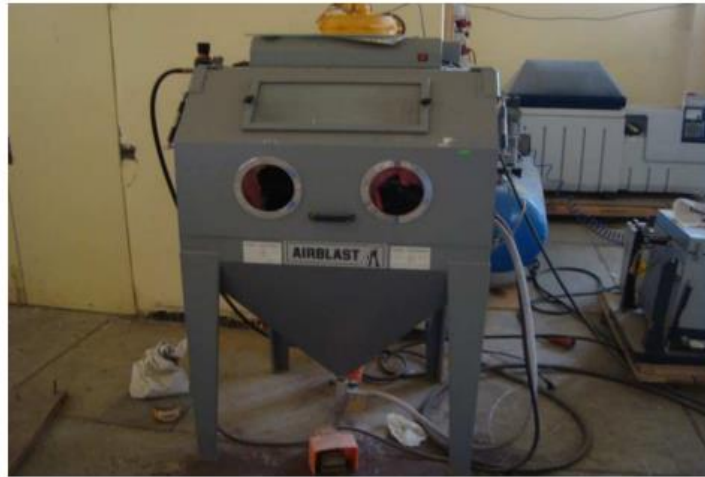
Figure II.5. Appareil de sablage.
