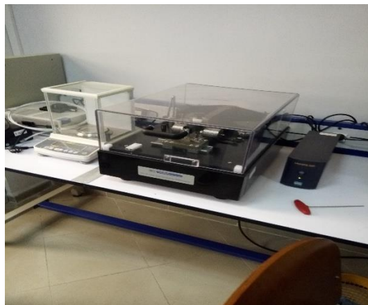
Figure II.11. Tribomètre NANOVEA T50 pion /plat.
