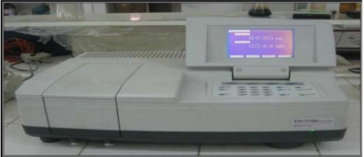
**Figure 11 :** schéma représentatif du spectrophotomètre UV-Visible de type SHIMADZU-1700
