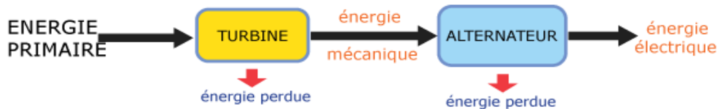
Figure 1.2 : Principe général de fonctionnement d'une centrale électrique
