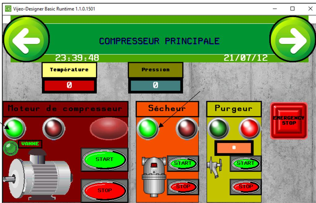
Figure 4.13 : Marche et arrêt le moteur et sécheur.
