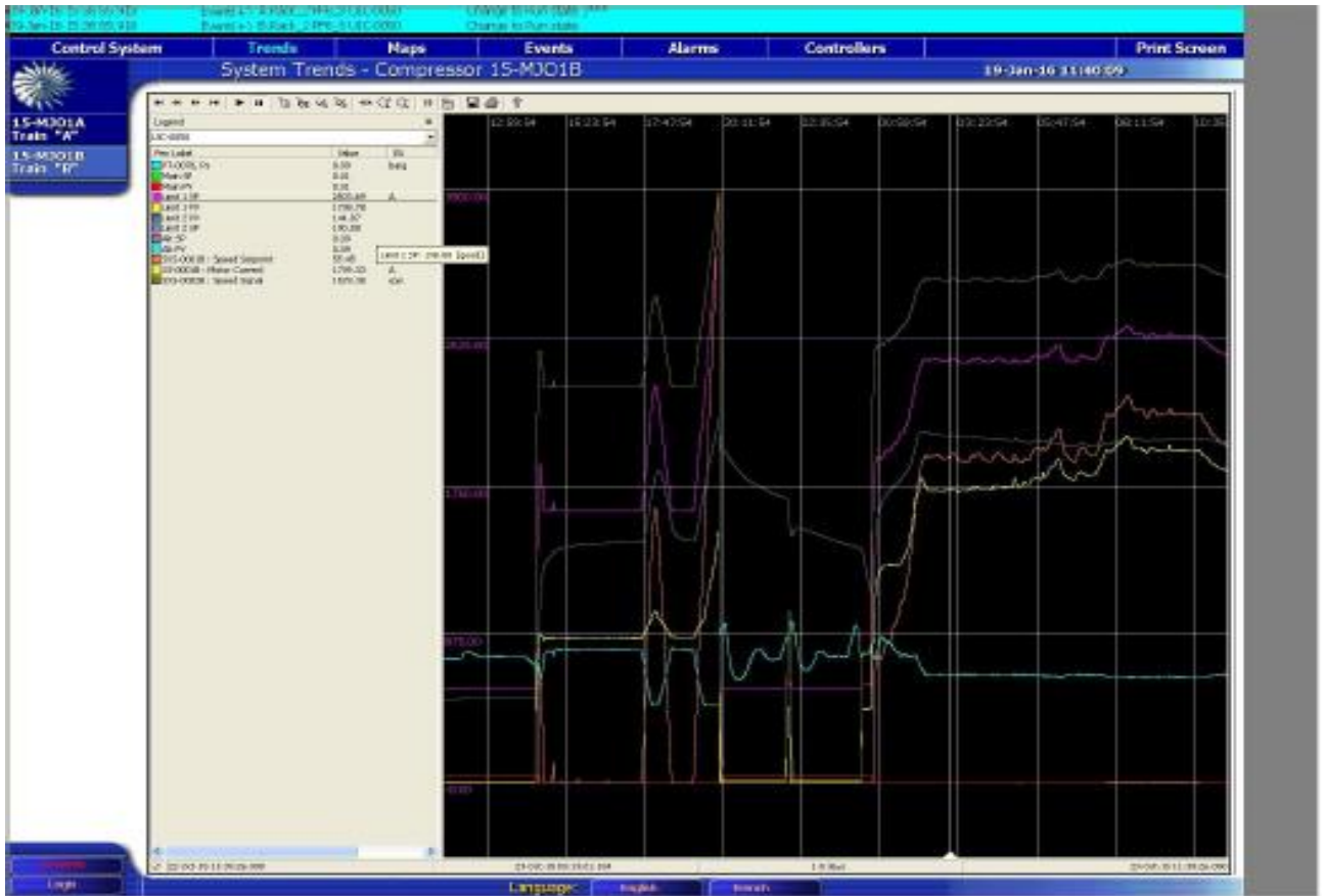
Figure 4.2 : Trip d'un compresseur End flash gas lors d'une redémarrage à chaud
