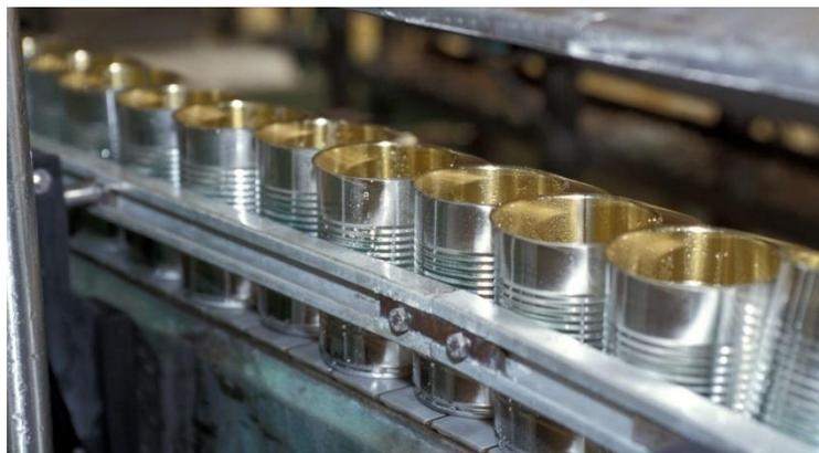
Figure 4.32 : Chaîne de pasteurisation [43]
