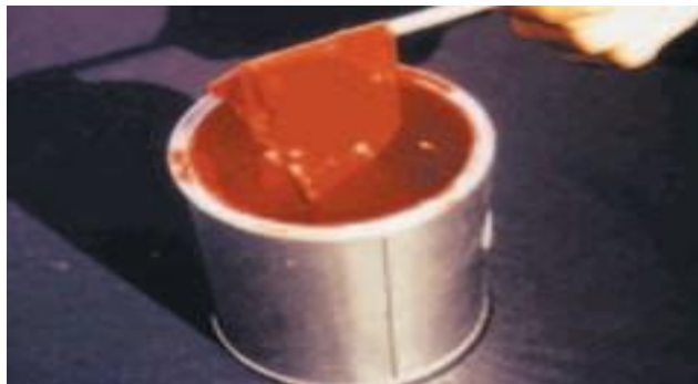
Photo II.2. Formation de peau sur la surface du la peinture liquide conditionnée dans un bidon (par BCA.2005)
