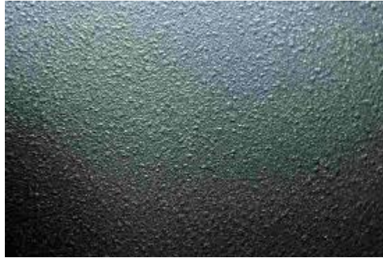
Photo II.10. Aspect granulé de la peinture (Bittiness) (par BCA.2005)
