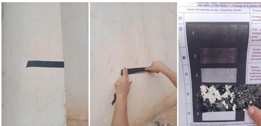
Photo IV.7. Détermination in situ de degré de farinage par la méthode du ruban adhésif (par l'équipe de CNERIB et rabah ben abbes & zekraoui)
