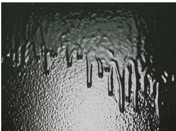
Photo II.5. Affaissement de la peinture (par Masud Rana)
