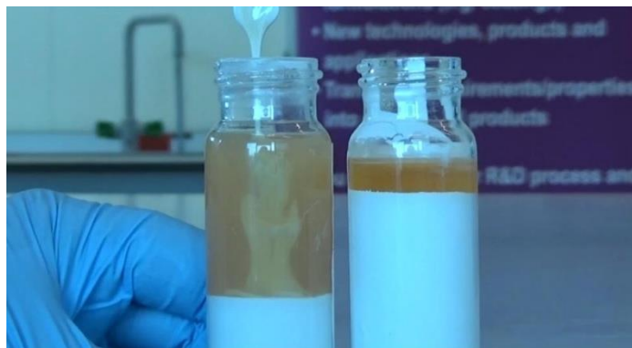
Photo II.1. Sédimentation de la résine de la peinture (par Jochum Beetsma) [12]
