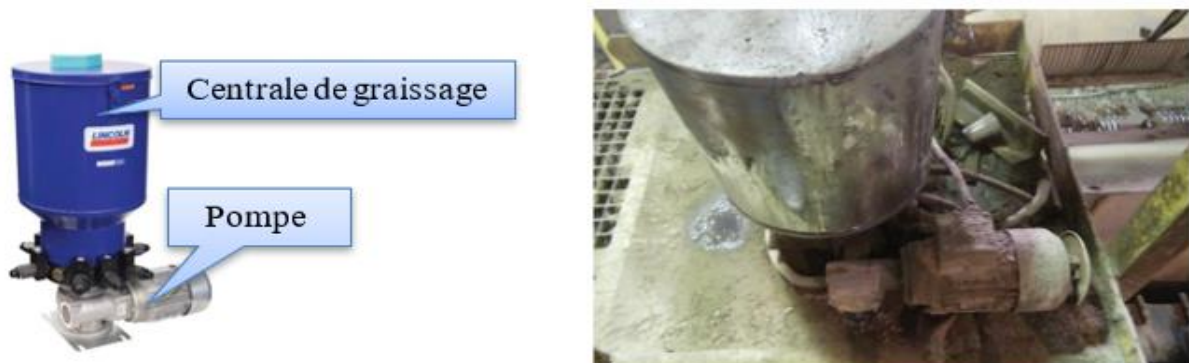
Figure 2.7 –Centrale de graissage.
