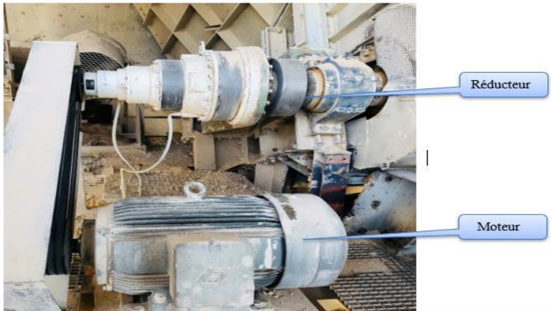
Figure 2.6 -Moteur associé à l'ATM avec réducteur de vitesse.
