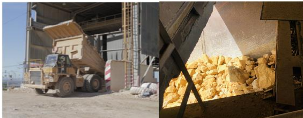
Figure 1.8 –Déchargement du calcaire dans l’atelier de concassage calcaire.
