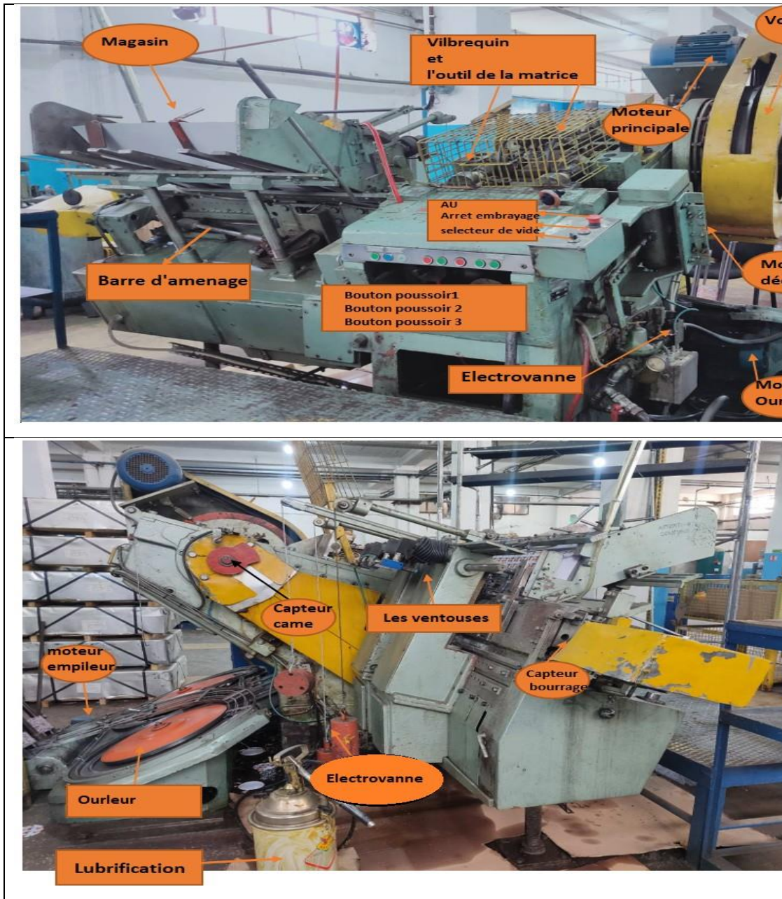
Figure II .7. Composants de la Presse KARGES Hammer
