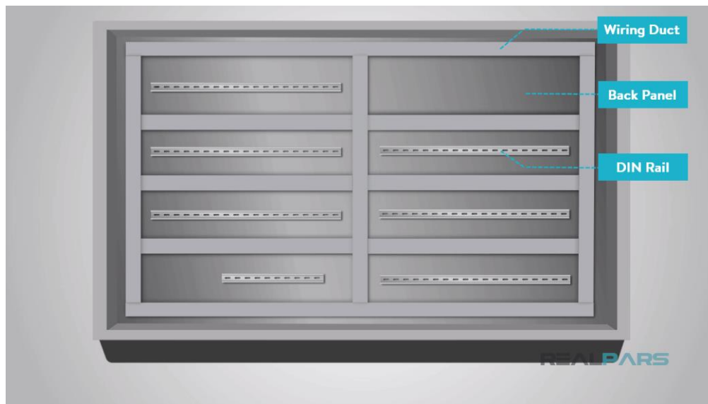
Figure IV.2. Composants non électriques[28]
