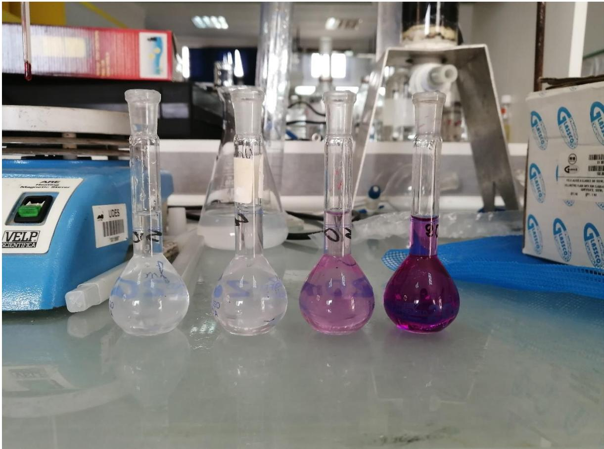
**Figure 24:** décoloration temporelle du colorant au cours de la dégradation.
