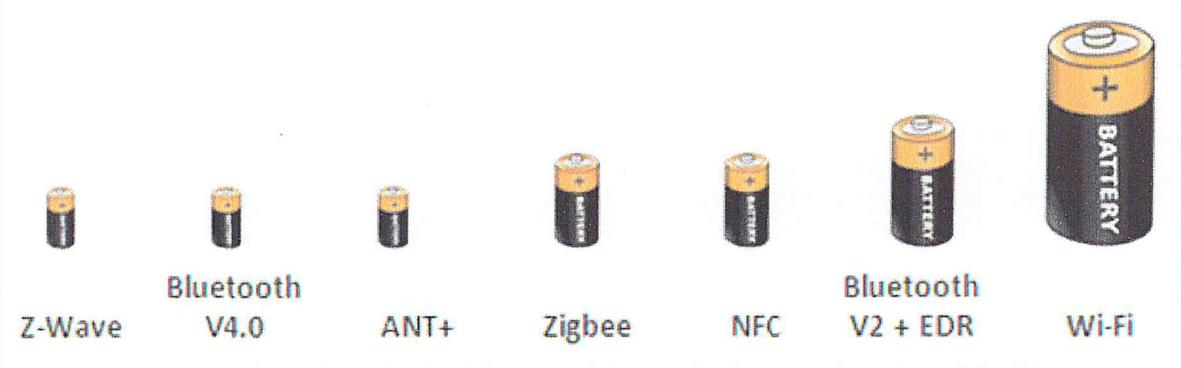
Figure II- 7: Comparaison de la consommation d'énergie des principaux standards de connectivité sans fil.
