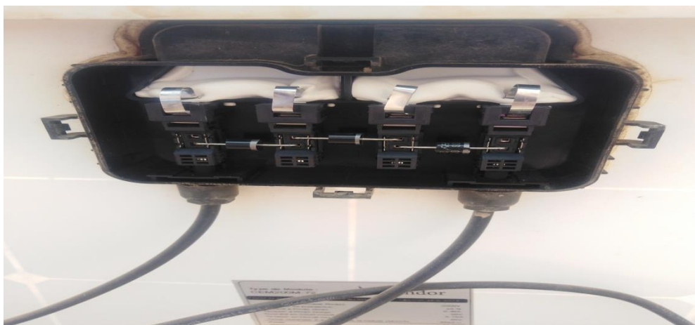
Figure III.11.1 : Boîte de jonction du module monocristallin avec trois diodes bypasse.
