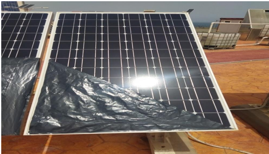
Figure III.5 : Module PV monocristallin ombragé partiellement
