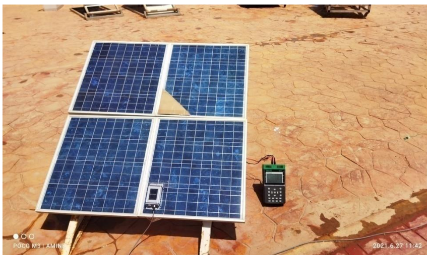
Figure III.6 : Module PV poly-cristallin ombragé partiellement
