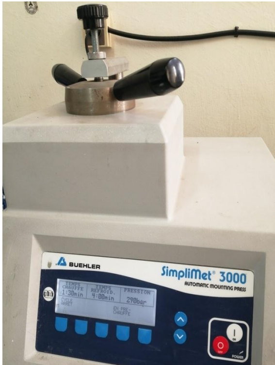
Figure III.5 : machine de l'enrobage
