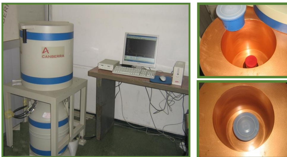
Figure III.5 : La chaîne de spectrométrie gamma avec un détecteur à semi-conducteur Ge (HP)
