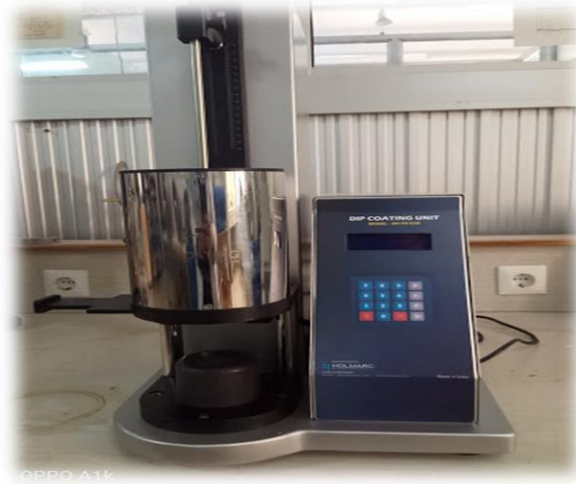
Figure II.1. Photographie du dispositif expérimental permettant le dépôt de nos couches par dip-coating
