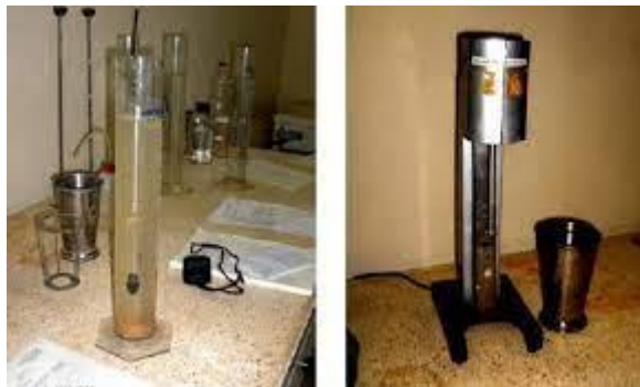
Figure II. 9: Granulométrie par sédimentométrie (Eprouvette et agitateur).
