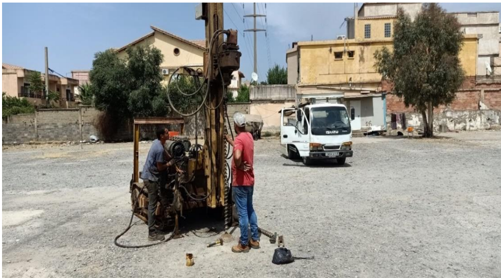
Figure II. 3: sondages à la tarière au site étudié.
