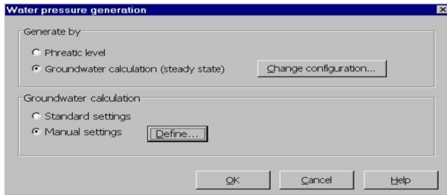
Figure III. 6: Fenêtre de génération des pressions hydrauliques.
