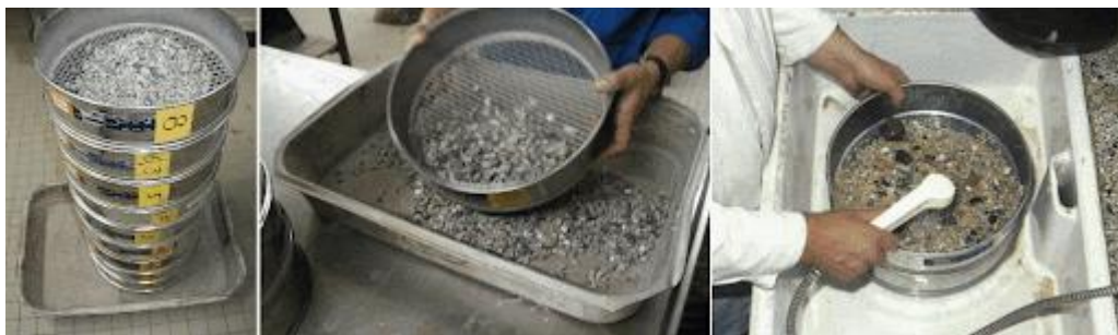
Figure II. 8: Granulométrie par tamisage. (Série de tamis).
