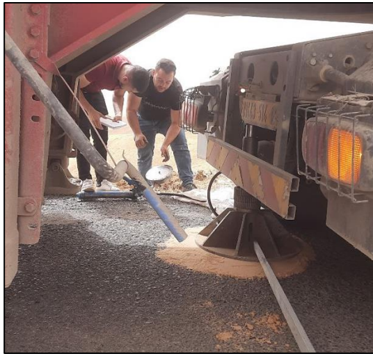
Figure I. 1: photos montrant l'essai à la plaque. (Route de El Omaria Médea ALGERIE).
