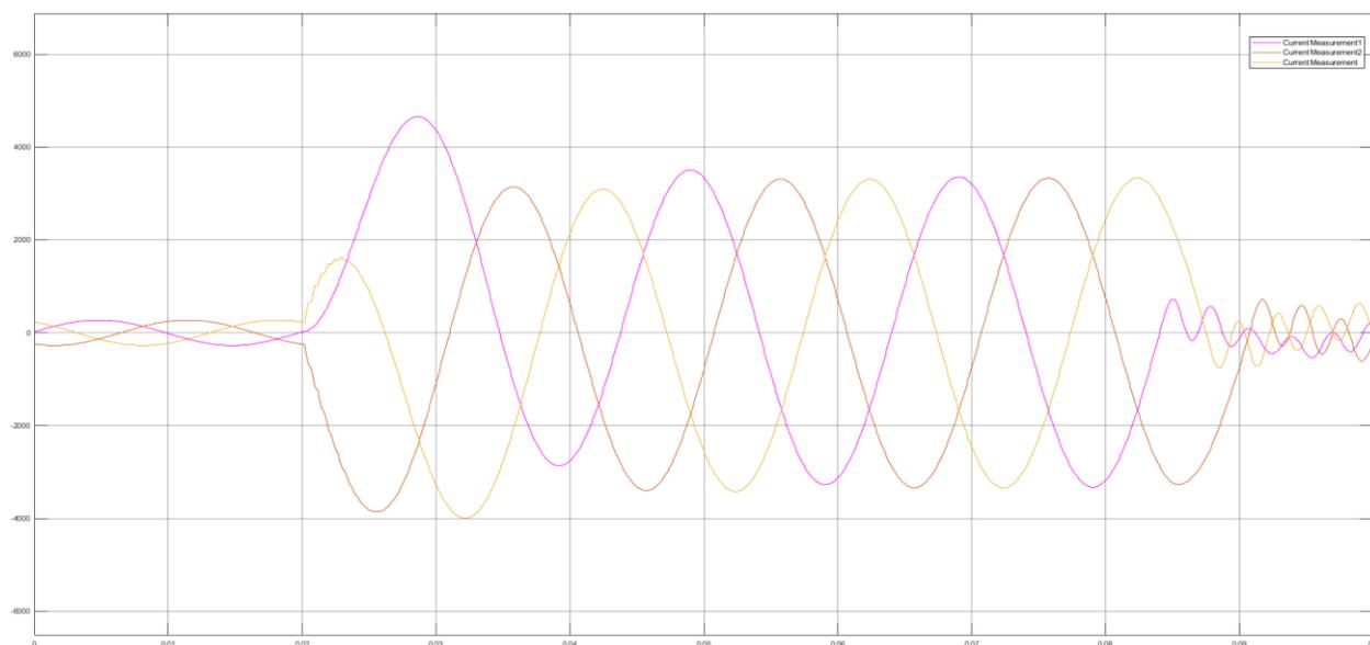
**Figure (3.9) :** Signaux des courants au jeu de barres ‘S’ pour un défaut triphasé à la terre avec  $R_f = 10 \Omega$  et  $m = 40\text{km}$ .
