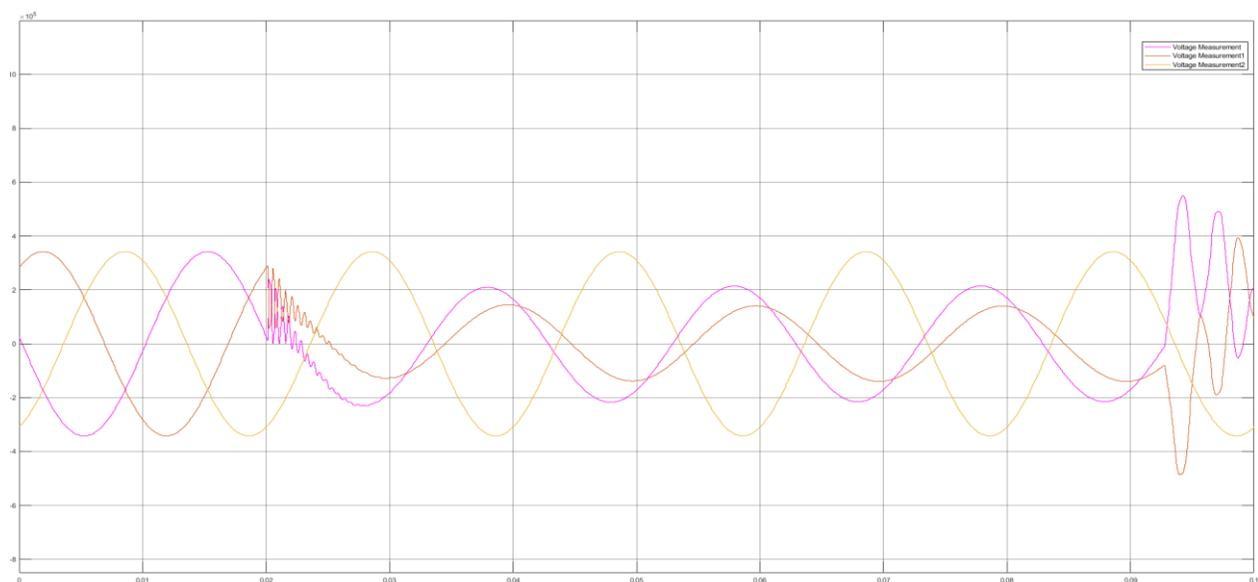
**Figure (3.6) :** Signaux des tensions au jeu de barres ‘S’ pour un défaut biphasé sans terre avec  $m = 40\text{km}$ .
