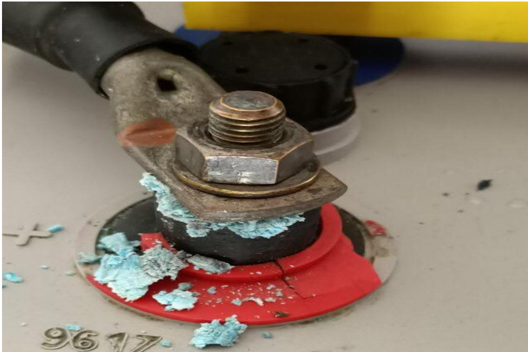
Figure 3- 7 accumulation de saleté dans les bornes de batterie
