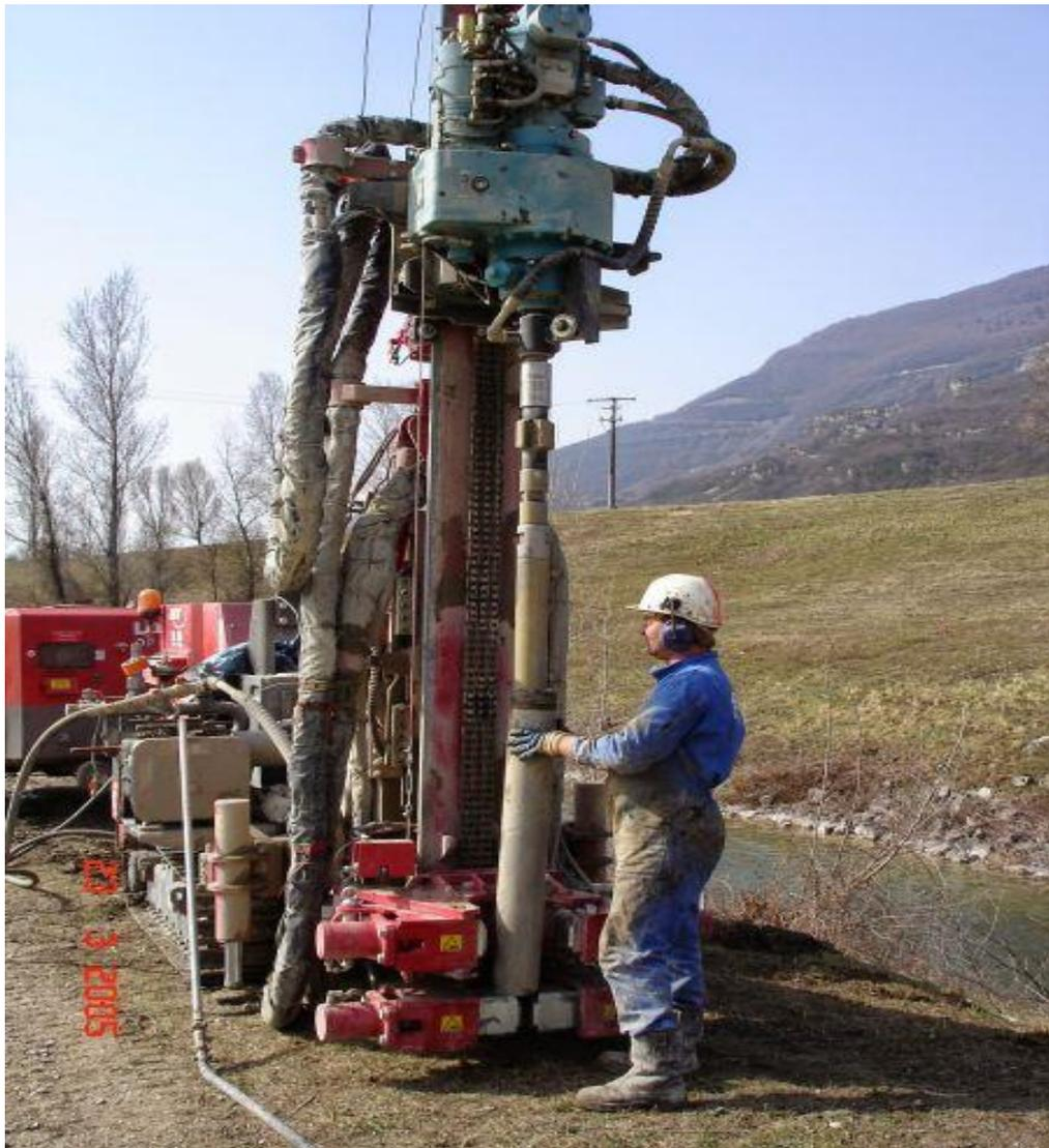
**Figure III. 2:** exemple prélèvement de sondage carotté
