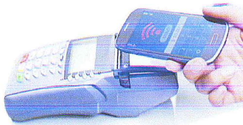
Figure 3 : Paiement via NFC
