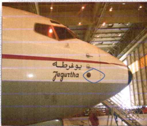
Figure III.3:(La sonde d'incidence AOA).
