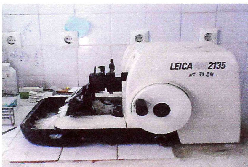
Figure n° 6 : Microtome pour la confection des coupes. « Type leica »
