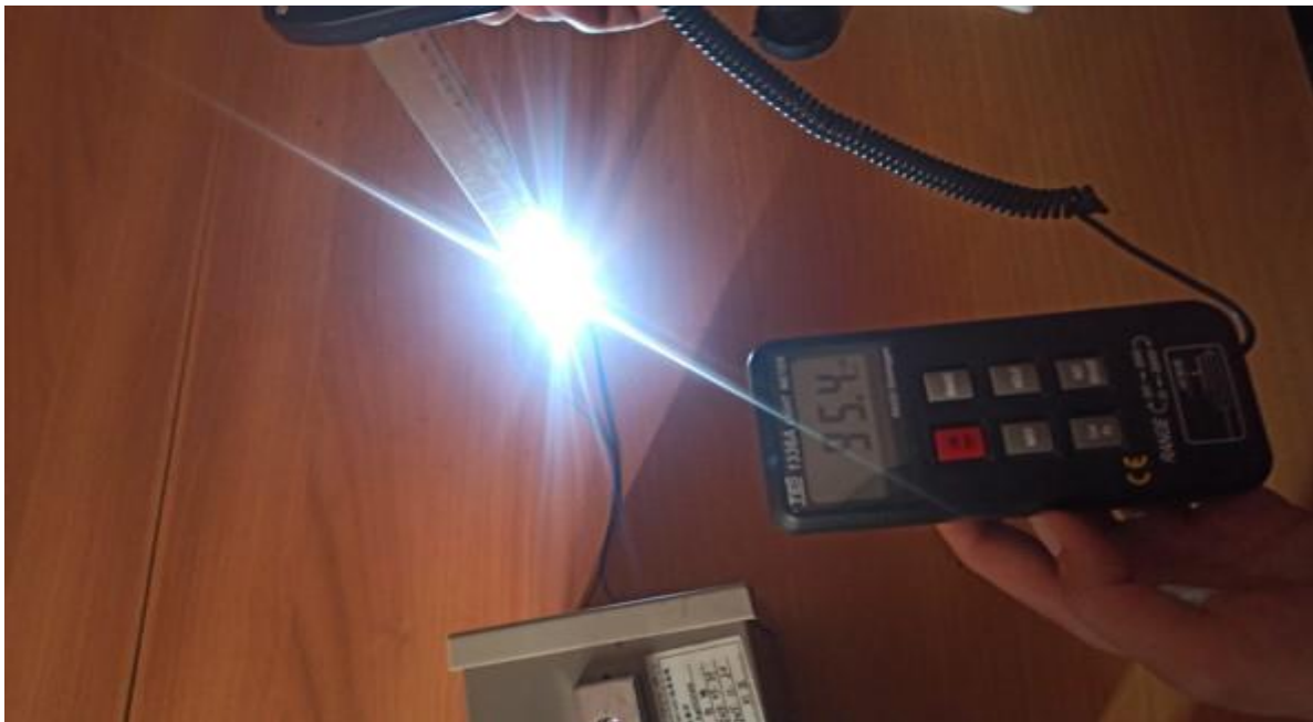
Figure 2.15 Calcul de l'éclairage par luxmètre
