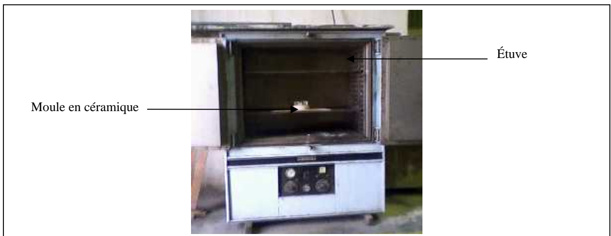
Figure [IV.103] : moule en céramique étuvé.
