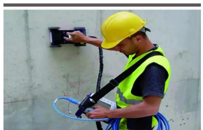
Figure I.21 : Mesure du potentiel de corrosion
