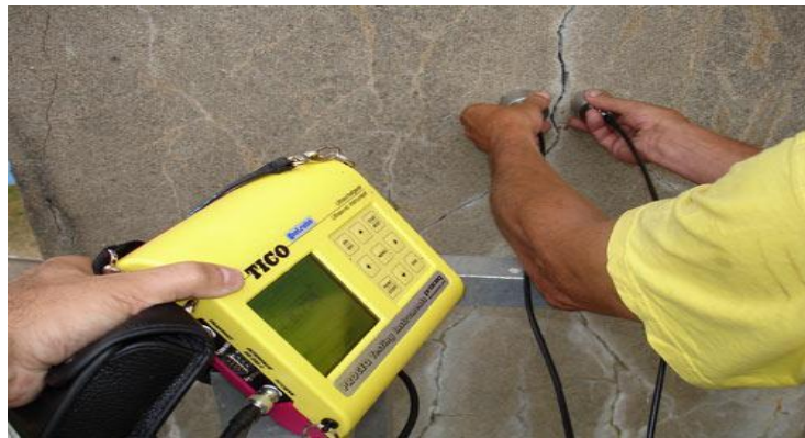
Figure I.17 : L'auscultation sonique des bétons
