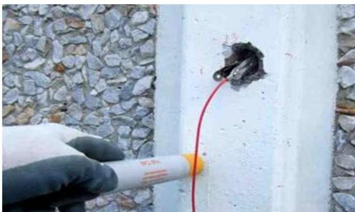
Figure I.21 : Mesure du potentiel de corrosion
